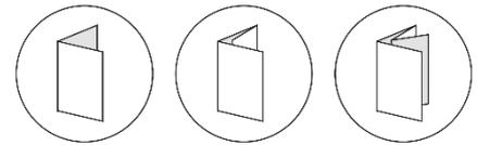
Zur Auswahl stehen alle modernen Falzarten, die im Bürobetrieb benötigt werden: Einfachfalz, Wickelfalz und doppelter Parallelfalz (v. l. n. r.).
